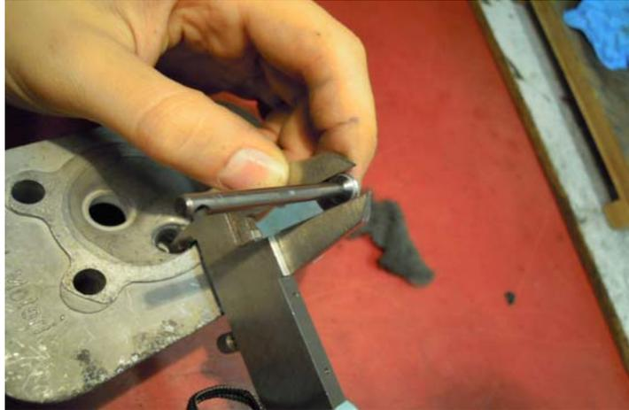
7) Puliamo la testa dall'abrasivo e prepariamoci a montare l'alzivalvola. Possiamo vedere che la superficie di appoggio della valvola non è perfettamente conica, potrebbe presentare una forma a piccoli scalini: non importa, l'importante è che faccia tenuta.
