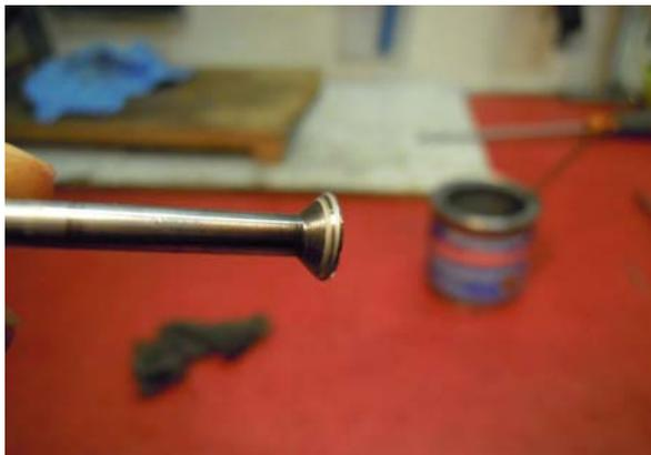
Ora possiamo controllare come ha agito l'abrasivo: si può notare che la superficie d'appoggio della valvola è limitata a 2 sottili corone circolari. E' preferibile fare in modo che tutta la superficie dell'alzivalvola vada in battuta nella sede.
