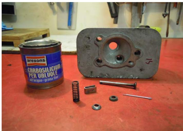
2) Spalmiamo un pò di abrasivo nella capocchia dell'alzivalvola facendo attenzione a non diluirlo troppo con l'acqua nella soluzione perchè potrebbe colare nella sede cilindrica ed asportare materiale. Aiutiamoci con un uncinetto o un piccolo cacciavite. Per evitare la classica fuoriuscita di olio che va a sporcare testa e pippetta è necessario che il gioco tra la zona cilindrica dell'alzivalvola e la guida nella testa sia il minore possibile.
