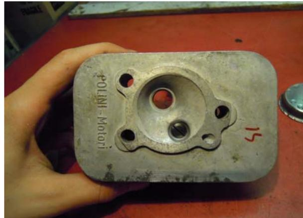
8) Per assemblare l'alzivalvola nella testa aiutiamoci appoggiando un dado M7 sul tavolo, possiamo sopra la testa in corrispondenza dell'alzivalvola, in modo che il dado tenga premuta nella sede la capocchia dell'alzivalvola, così facendo risulterà più semplice infilare la copiglia nel foro della valvola.
